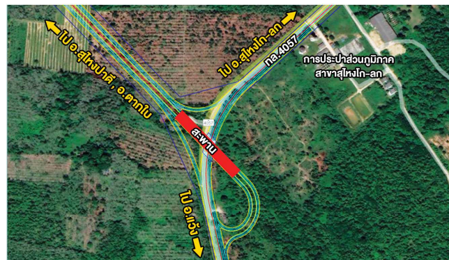
รูปแบบที่ 2 รูปแบบทางแยกต่างระดับแบบ Trumpet Type ยกข้ามทางหลวงหมายเลข 4057
