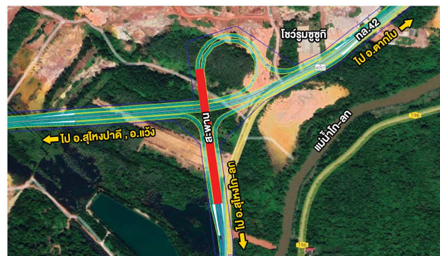
รูปแบบที่ 3 ทางแยกต่างระดับยกข้ามแนวเส้นทางเลี่ยงเมืองรูปแบบ Trumpet Type
