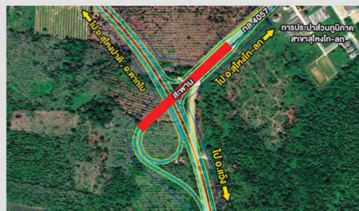
รูปแบบที่ 3 รูปแบบทางแยกต่างระดับแบบ Trumpet Type ยกข้ามทางเลี่ยงเมือง
