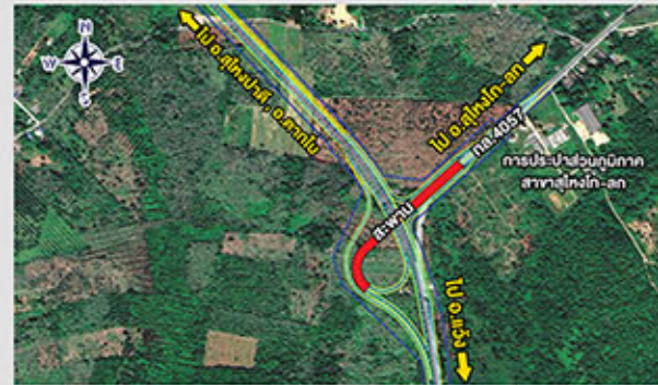
รูปแบบที่ 3 รูปแบบทางแยกต่างระดับแบบ Trumpet Type ข้ามทางหลวงหมายเลข 4056
