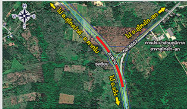
รูปแบบที่ 1 โครงสร้างสะพานข้ามทางแยกและการจัดการจราจรด้วยรูปแบบวงเวียน
