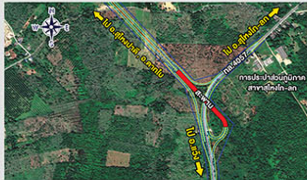
รูปแบบที่ 2 รูปแบบทางแยกต่างระดับแบบ Trumpet Type ข้ามทางหลวงหมายเลข 4057
