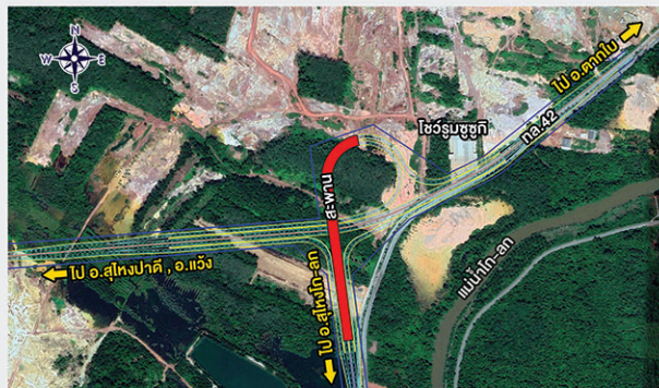
รูปแบบทางเลือกที่ 3 ทางแยกต่างระดับยกข้ามแนวเส้นทางเลี่ยงเมืองรูปแบบ Trumpet Type
