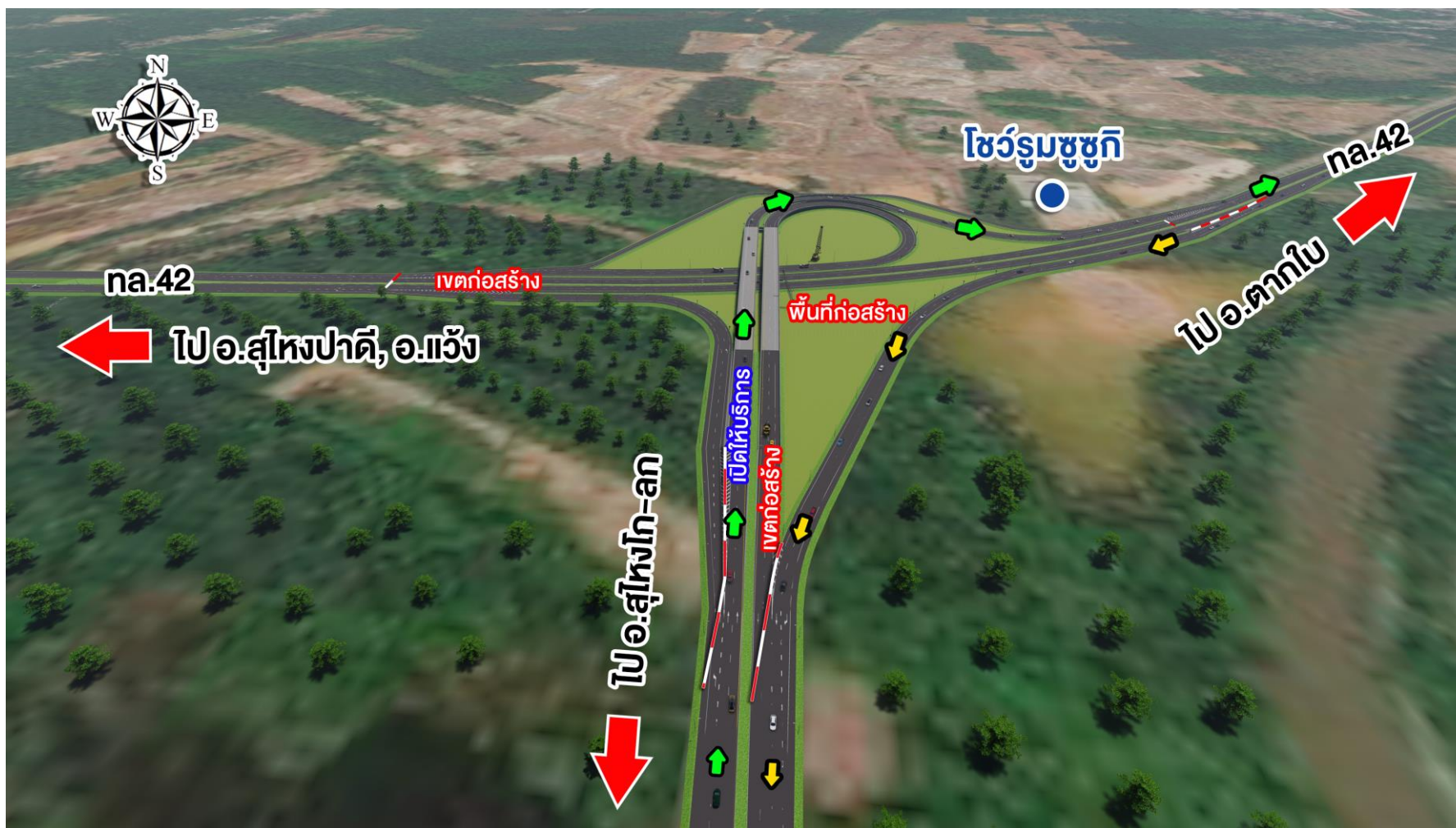
รูปที่ 5.5-5 ตัวอย่างการจัดจราจรระหว่างก่อสร้างบริเวณจุดสิ้นสุดโครงการ ทล.42 ระยะที่ 2
