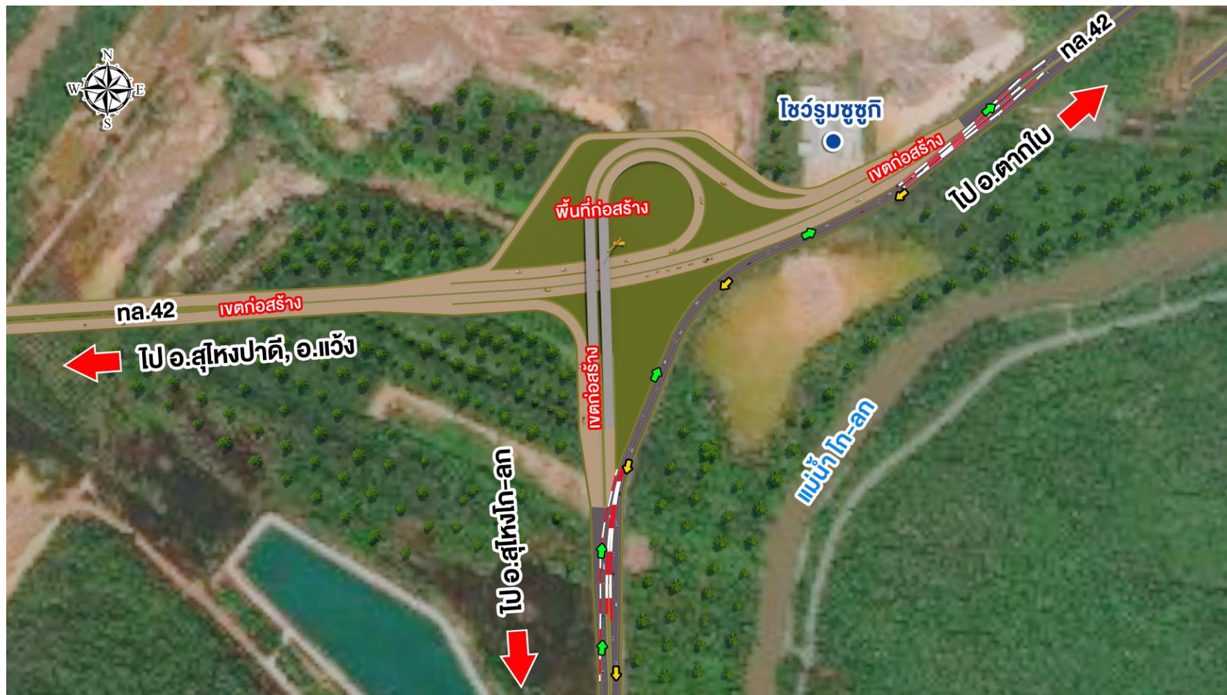
รูปที่ 5.5-4 ตัวอย่างการจัดจราจรระหว่างก่อสร้างบริเวณจุดสิ้นสุดโครงการ ทล.42 ระยะที่ 1
